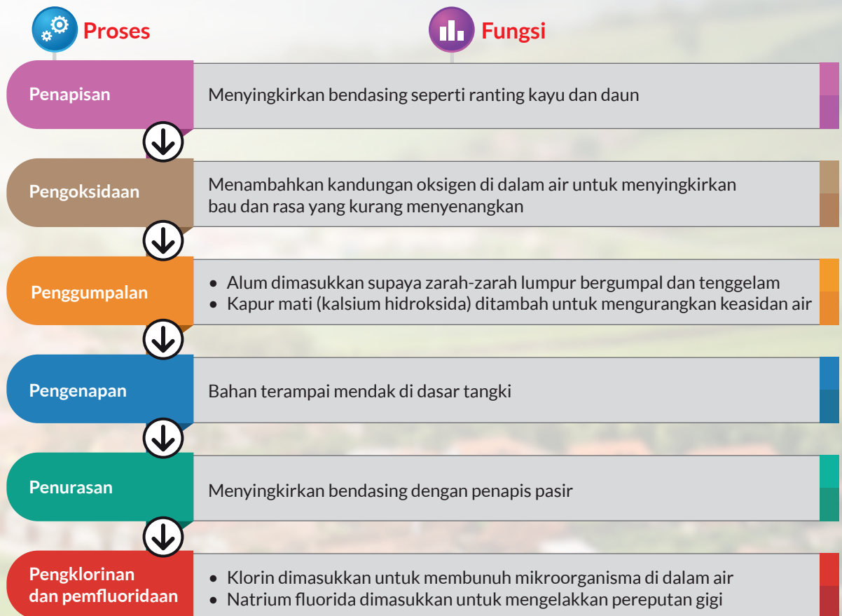
Rajah 5.24 Proses pembersihan air
